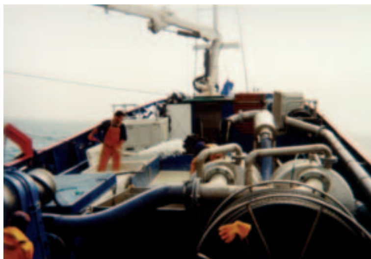
Pre-enfriamiento del pescado antes de almacenarlo en la bodega refrigerada
